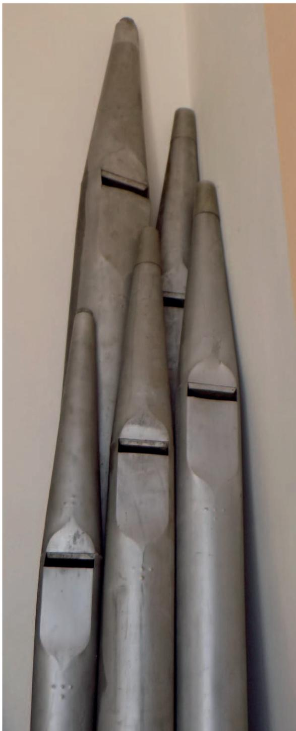
Obr. 5. Část původních píšťal prospektové pedálového rejstříku Octava 8' (Foto: Jan Gottwald 2020)
