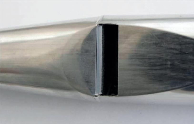
Obr. 3. Labium měřených píšťal ve výchozím stavu.
