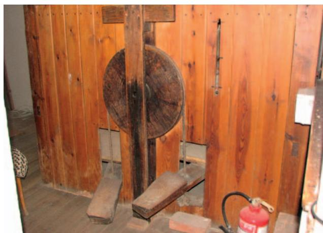
Fot. 18. Obudowa miecha z dźwigniami kalikanta
